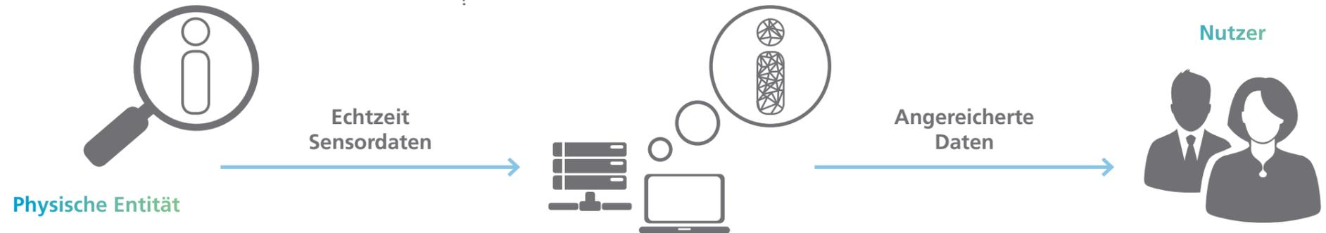
Abb. 1: Grundstruktur eines digitalen Zwillings. Bitte beachten Sie, dass in der Anwendung der Informationsaustausch zwischen den verschiedenen Entitäten wesentlich umfangreicher und komplexer sein kann, da die vom Benutzer über den digitalen Zwilling gewonnenen Erkenntnisse in den Betrieb der physischen Entität und des digitalen Zwillings zurückgeführt werden können.
