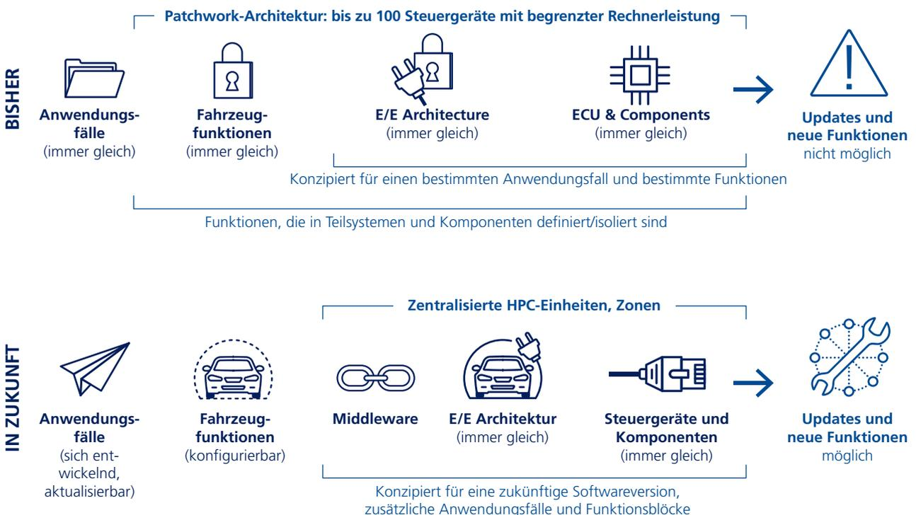
Abb. 9: Entwicklung der Fahrzeugmodelle von festen Funktionen hin zu einer ständig möglichen Weiterentwicklung
